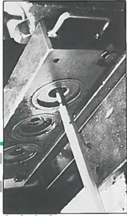
Le mandrin, enfilé dans le tube, est introduit dans la filière.
